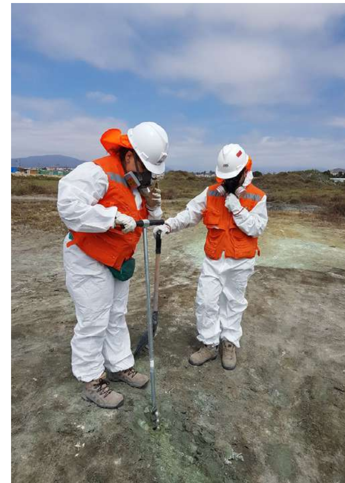
Figura 9: Sondaje Manual tipo barreno: Uso y partes que lo conforman
