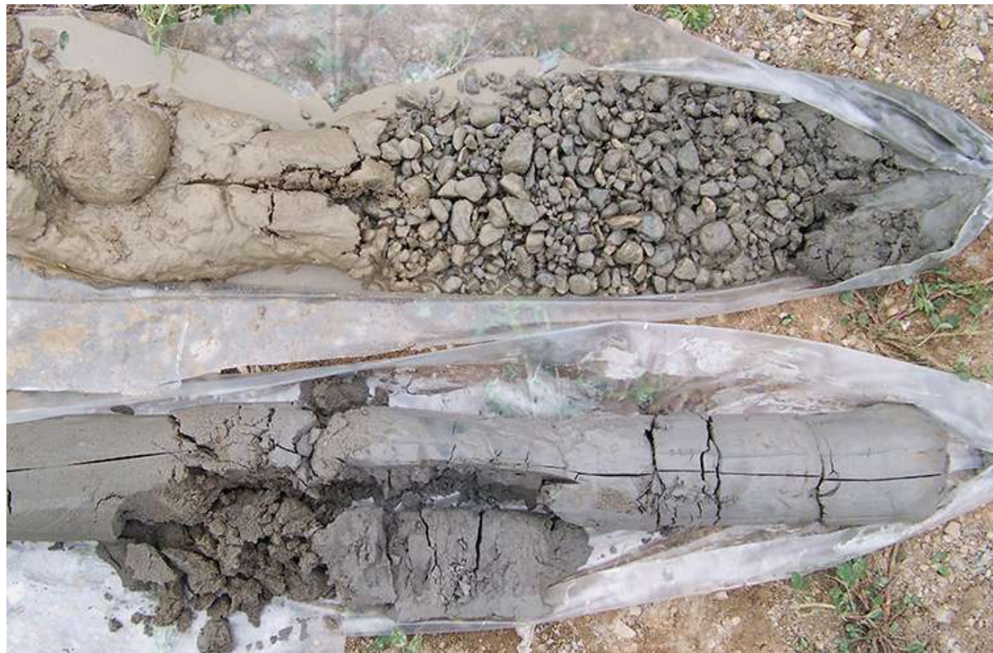
Figura 10: Muestras obtenidas en sondajes con sonda sónica
