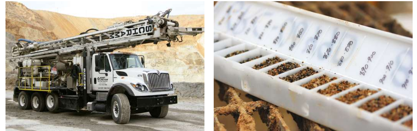
Figura 5, Izq.: Maquinaria de Sondaje Reverso. Der.: Muestras obtenidas mediante sondaje de Aire Reverso
