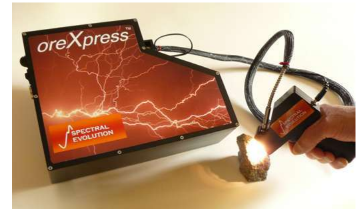
Figura 30: Equipo portátil de espectroscopia infrarroja cercana
